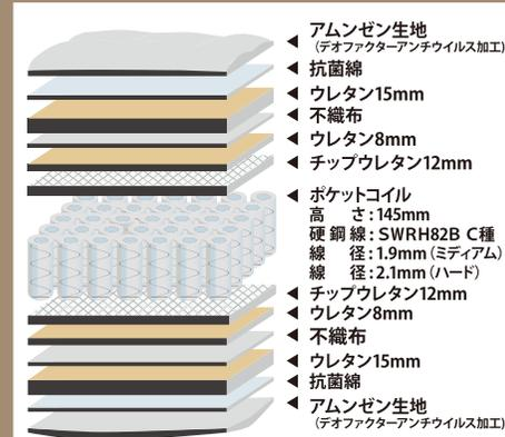
JIS最高クラスの硬鋼線が独特の弾力とコシを生み出し快適な寝心地を体感できます
